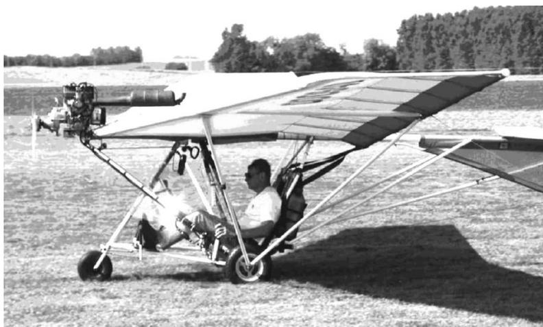
**FIG. 1 – Weedhopper (uno dei primi ULM: Ultraleggeri a Motore)**
